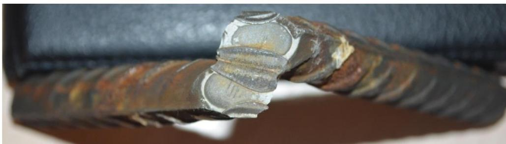
Рис. 3. Макрошлиф сварного соединения арматурных стержней по стандартному технологическому процессу
