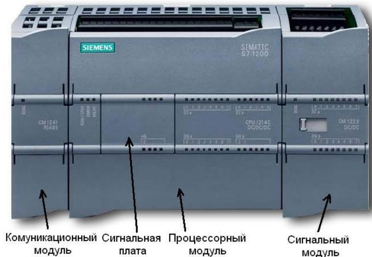
Рис. 2 Общий вид ПЛК S7-1200 фирмы *Siemens*
