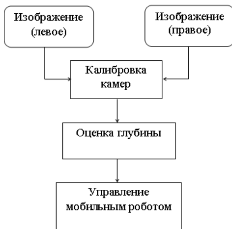
Рис. 4. Структурная схема проектируемой бинокулярной системы
