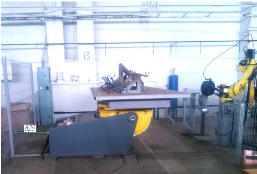
Рис. 2. Сервопозиционер *TR 4501* в составе РТК
