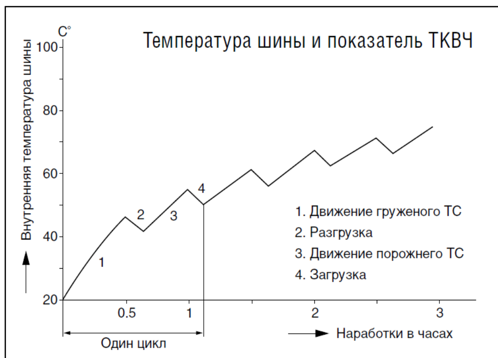
Рисунок 2 – Зависимость внутренней температуры шины от показателя ТКВЧ
