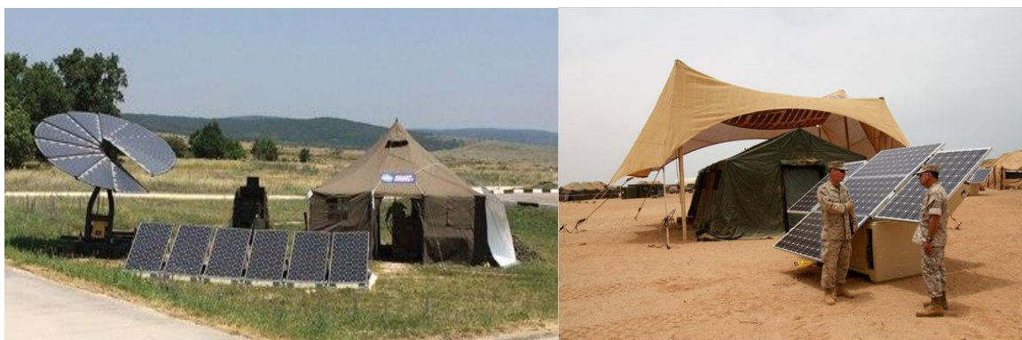
Рисунок 6 – Автономные источники электроэнергии с фотоэлектрическими преобразователями
