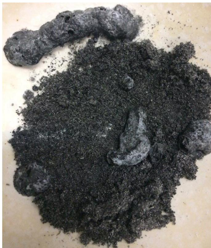
Рис. 2. Нелетучий остаток, полученный после определения выхода летучих из отрубей
