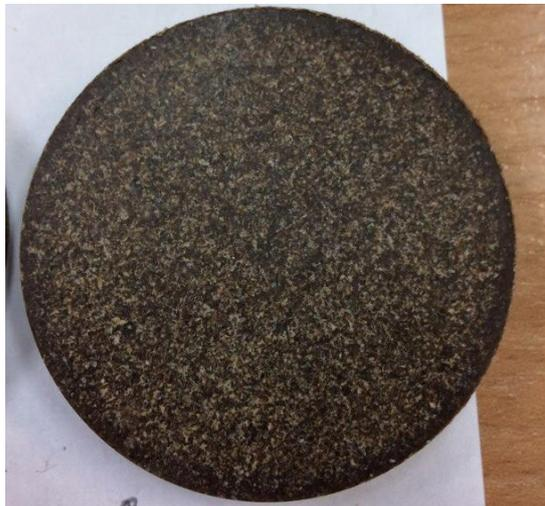
Рис. 3. Брикеты, полученные термическим прессованием отрубей:
