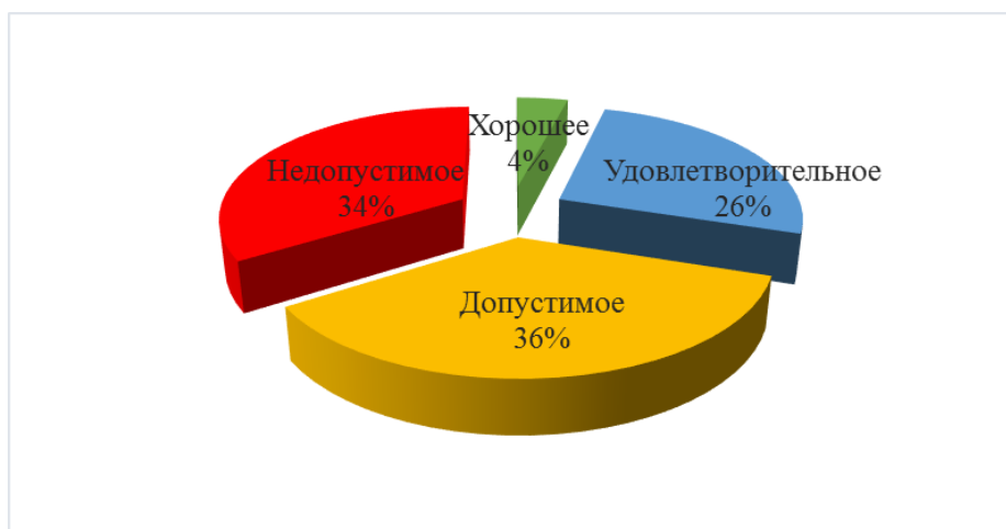
Рисунок 1 - Состояние парка экскаваторов по первичным данным вибродиагностики
