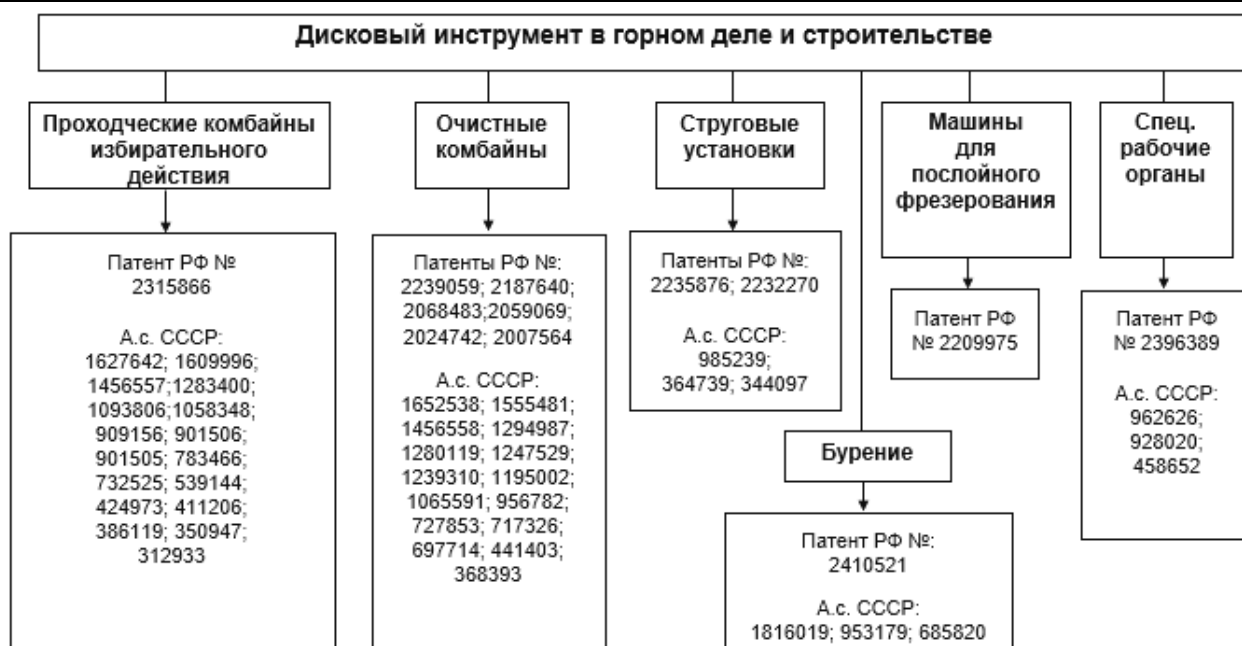
Рис. 3. Использование дискового инструмента на рабочих органах горных и строительных машин
