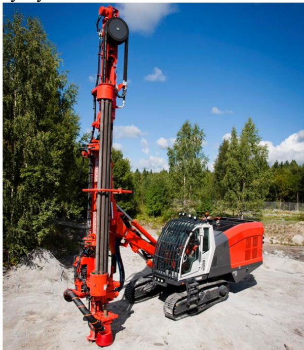
Рис. 3. Буровой станок с гидравлически управляемым наклоном мачты.
