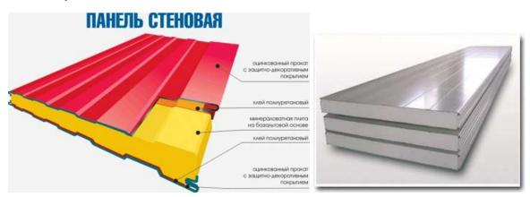
Рассмотрим в качестве примера возведение жилого малоэтажного здания в Сибири г. Кемерово. Из расчета средних температур в разных районах толщина стен будет составлять от 120 до 250 мм. Хочется заметить, что по
