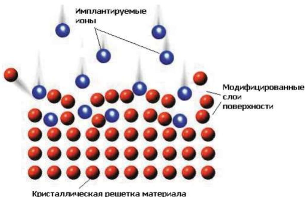
Рис.1. Процесс ионной имплантации
