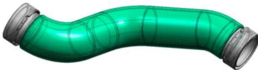
Рисунок 4 – Электронное макетирование трубы воздушного охлаждения
