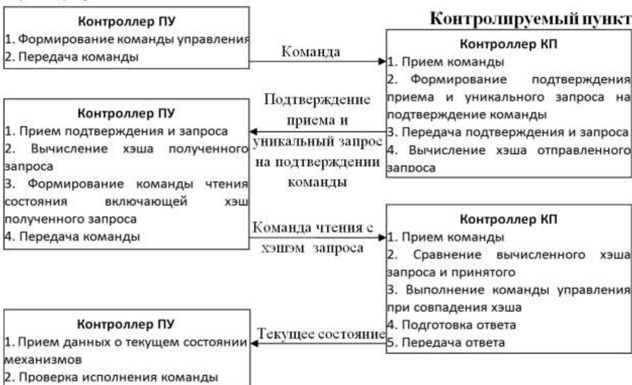
Рисунок 1. Алгоритм дистанционного управления механизмом
