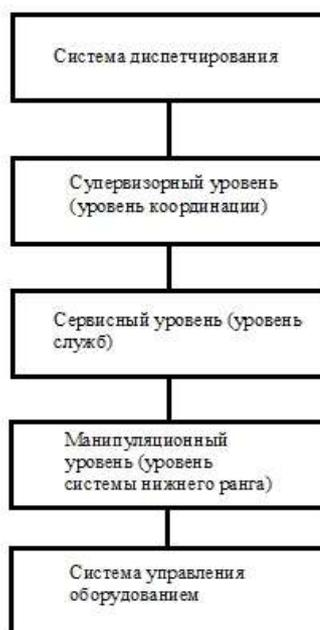
Рис. 2. Информационные потоки в системе управления автоматизированным цехом
