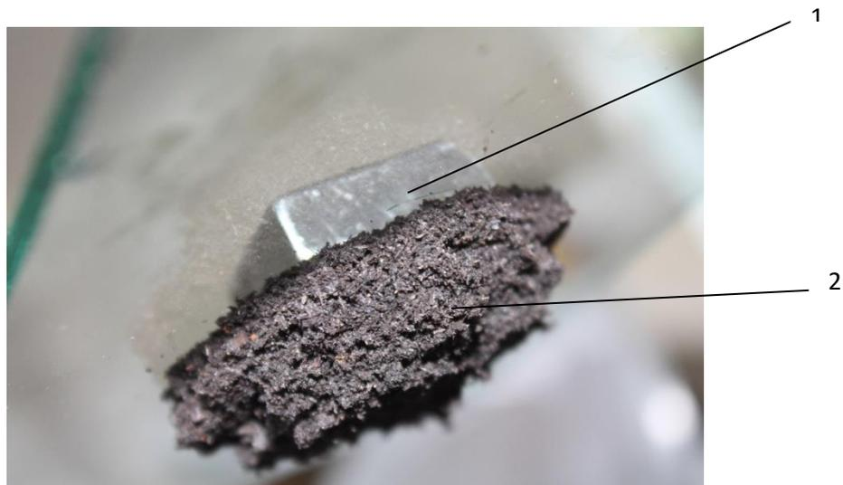
*Рис.1. Магнитоуправляемый гидрофобизированный нефтесорбент «Магнесорб»: 1 – постоянный магнит; 2 – сорбент (порошок)*
