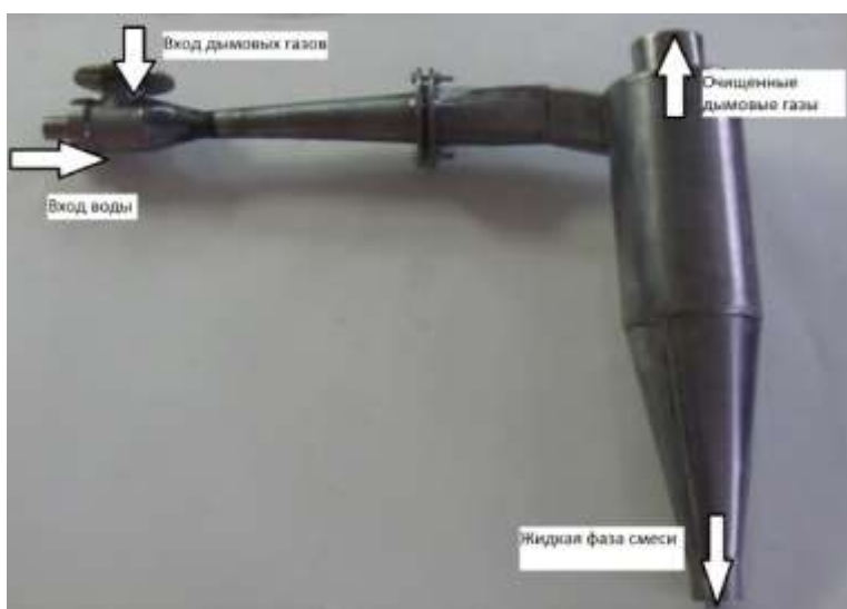
Рис. 2. Скруббер Вентури и циклон
