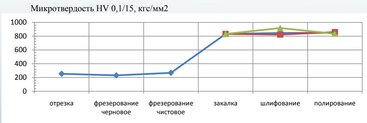
Рисунок 6 - Графики значений микротвердости на стадиях обработки
