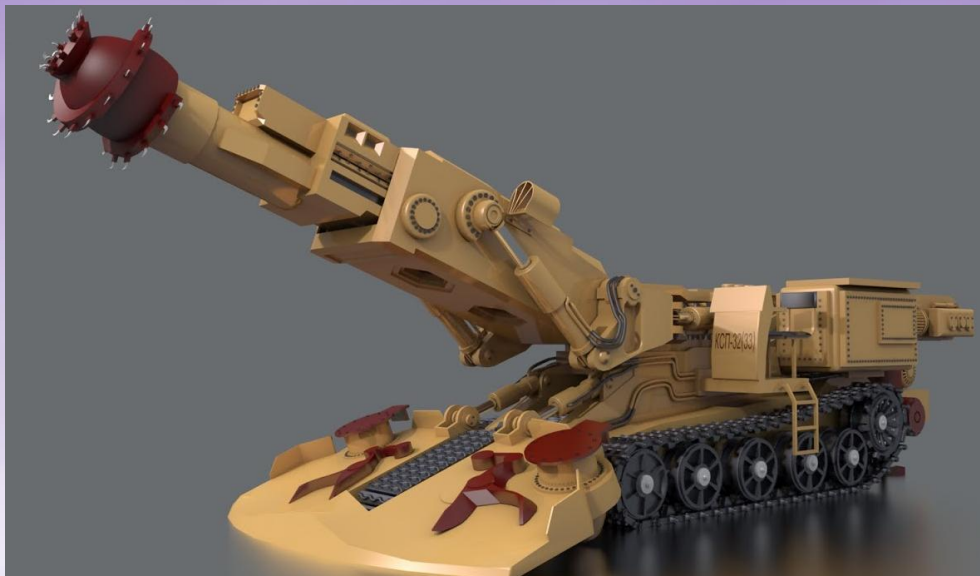
Рисунок 3 - Горнопроходческий комбайн КСП-32(33)
