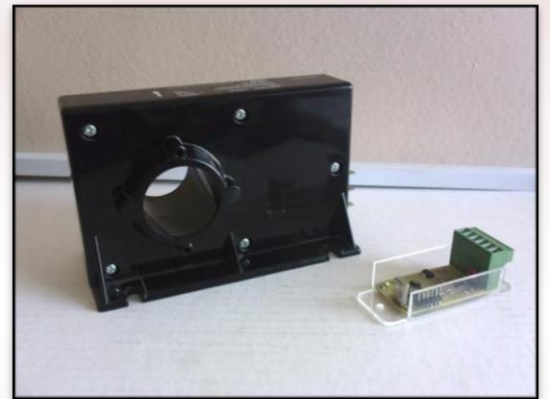
Рисунок 3 - Датчики высоких токов. Справа – разработанное устройство, слева – промышленный аналог со схожим значением максимального тока
