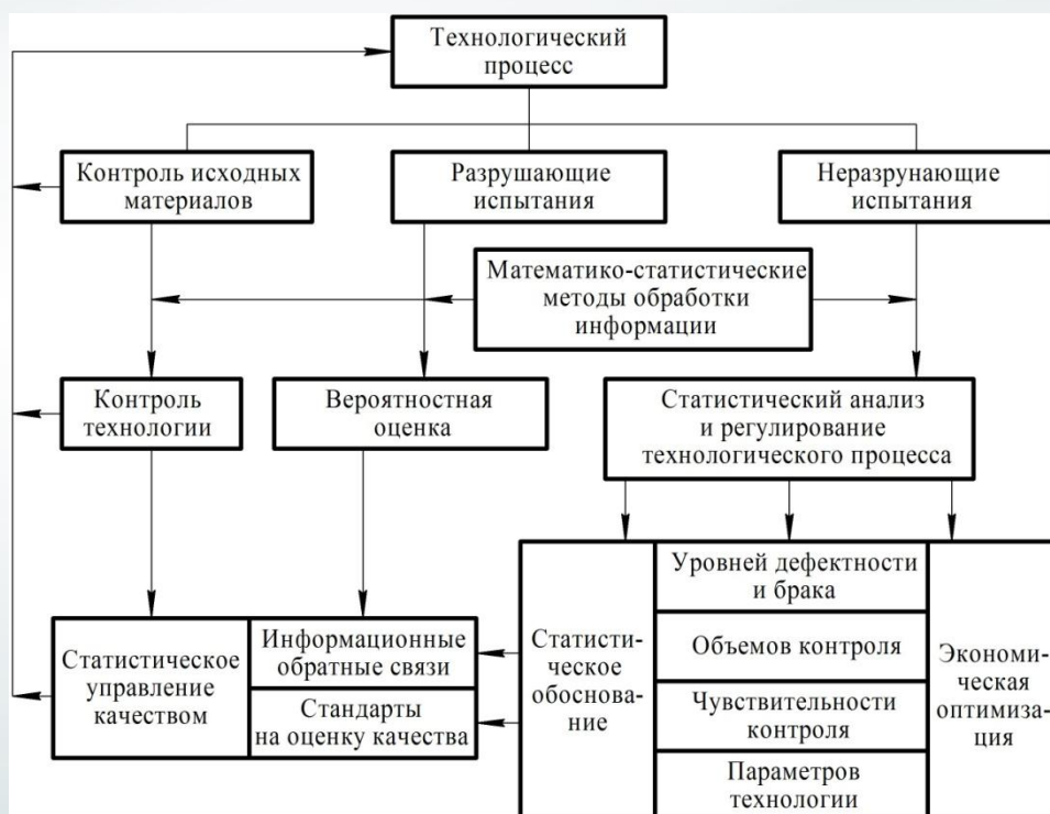
Рисунок 1 - Технологический процесс контроля качества
