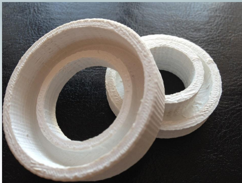
Рисунок 3 - Элементы лабиринтного уплотнения изготовленные технологией FDM
