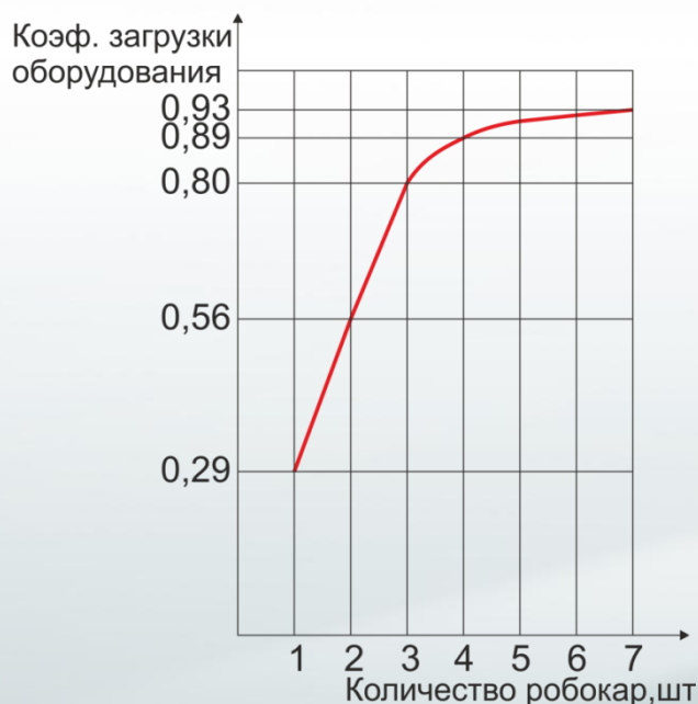
Рисунок 3 - График зависимости коэффициента загрузки оборудования (наиболее загруженного участка технологической цепочки) от количества роботизированных тележек
