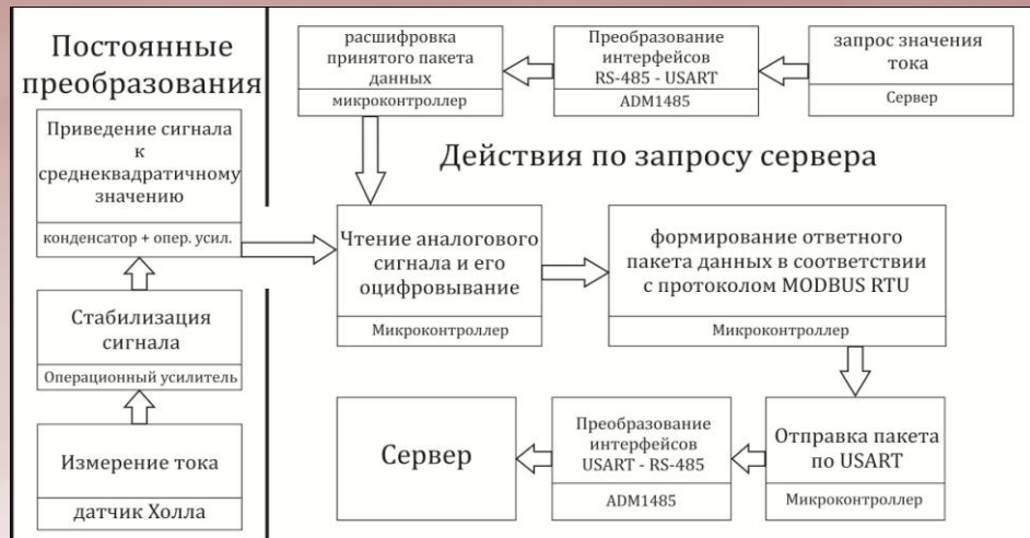
Рисунок 2 - Схематическое представление принципа действия датчика тока
