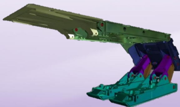
Рисунок 2 – Готовая сборка секции механизированной крепи М138
