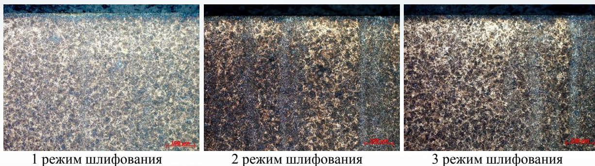
Рисунок 8 – микроструктура образцов после операции полирования
