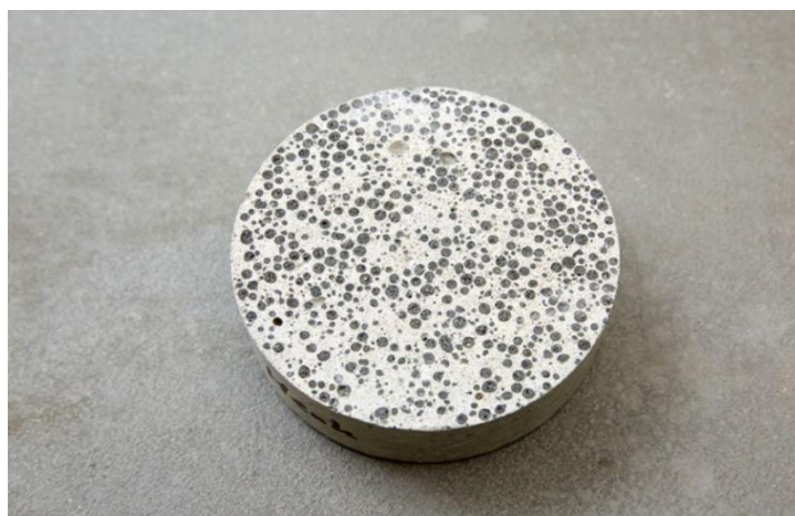
Рисунок 2 – Образец самовосстанавливающегося бетона
