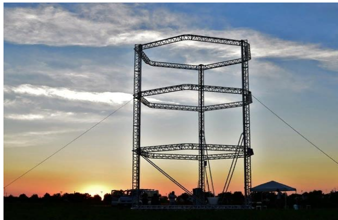
Рисунок 4 – Строительный 3-D принтер BigDelta
