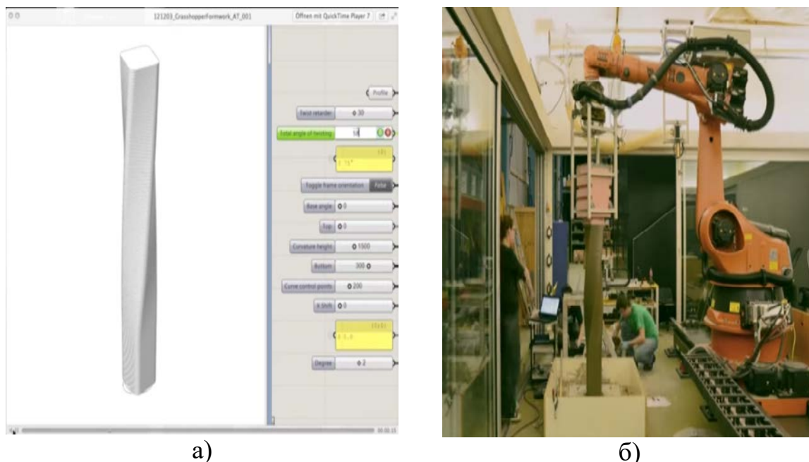
Рисунок – Возведение колонны методом умного динамического литья»: а) цифровая 3D-модель; б) процесс производства.
