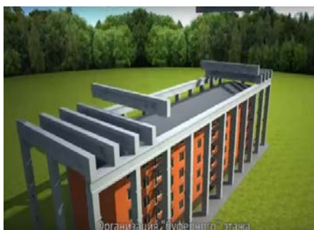
Рисунок 3 – Возведение защитного этажа
