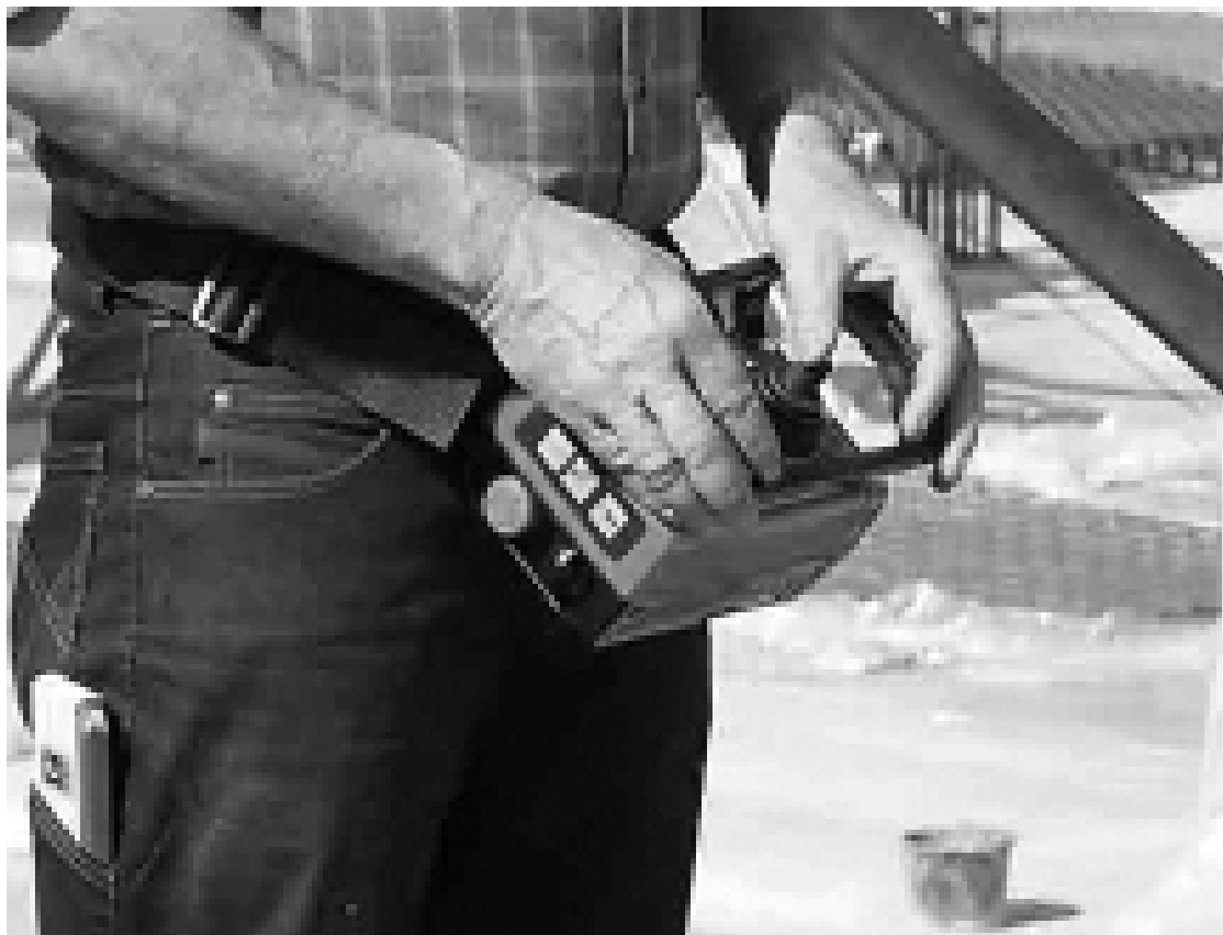
Рисунок – Радиоуправление монтажника краном
