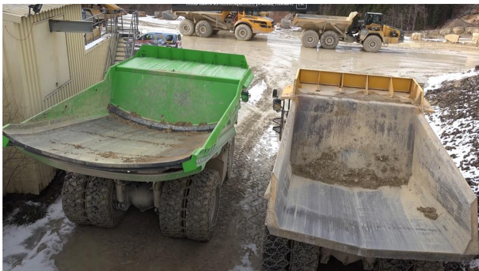
Рисунок 2 - eDumper с Duratray слева, Komatsu с заводским кузовом справа
