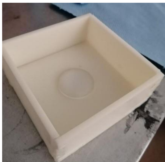
Рисунок 2 - Подготовленная мета-форма для литья силикона с применением эталонной линзы
