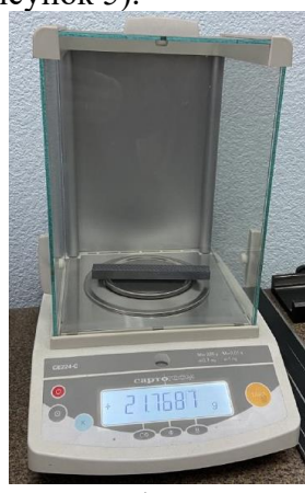
Рисунок 5 - Взвешивание образца на аналитических весах
