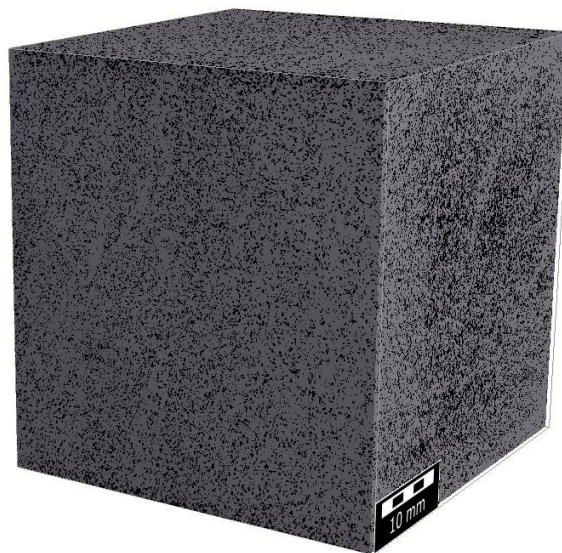
Рисунок 1 - Полученная в результате сегментации структура породы
