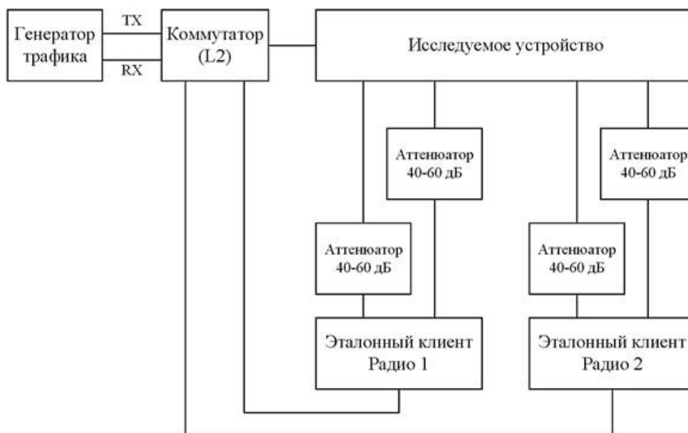
Рисунок 2 - Модель измерений MIMO 2x2
