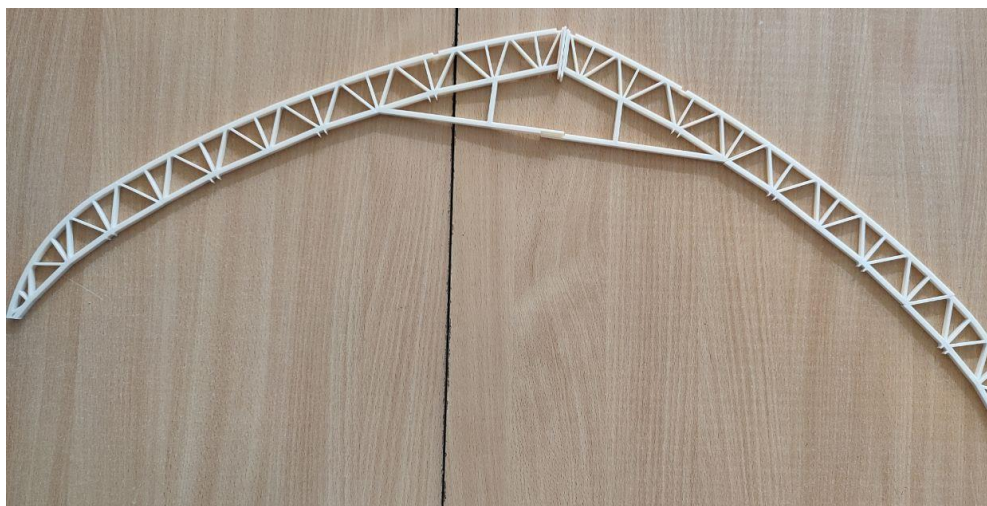
Рисунок 4 – Арка рядовых конструкций макета теплицы
