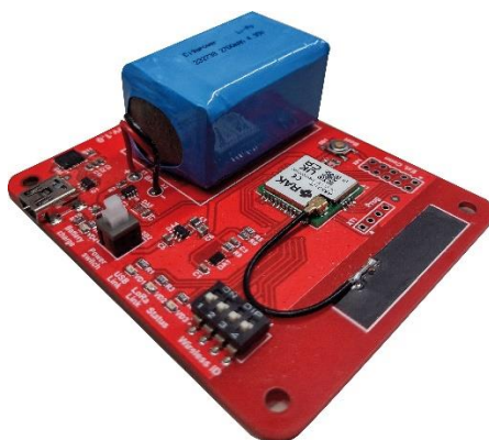
Рисунок 3 - Пример аппаратной платформы для конечных узлов архитектуры
