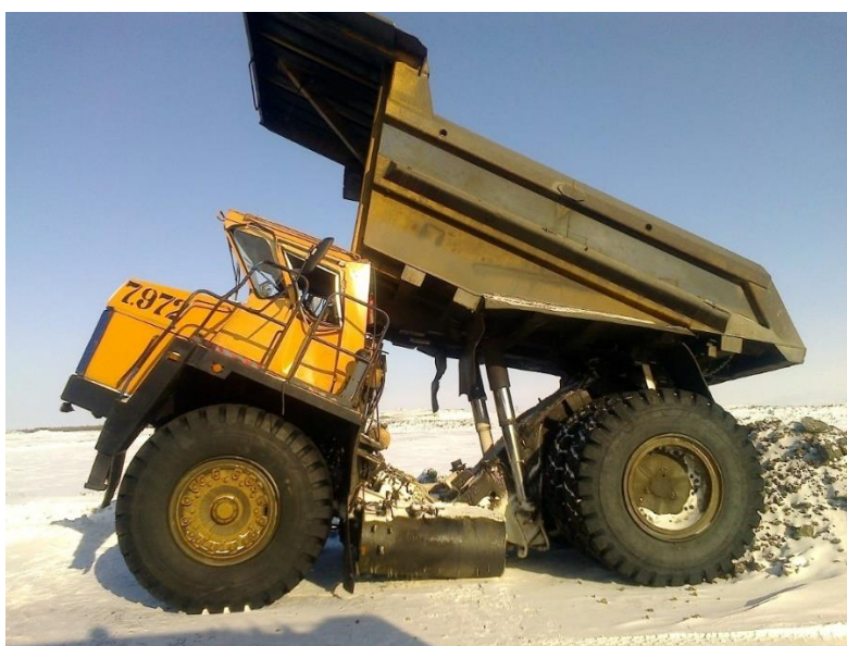
Рисунок 1 - Пример перелома рамы
