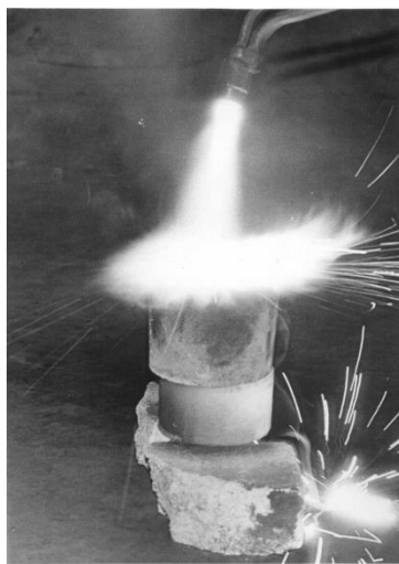
б) поджигание термитной шихты
