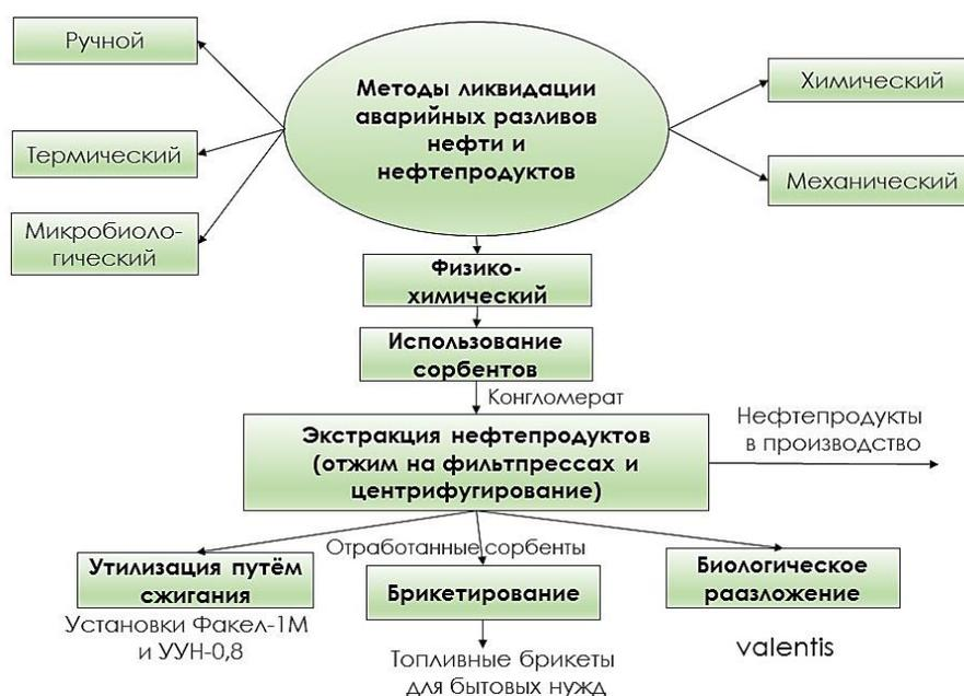
Рис. 1. Блок-схема методов ликвидации аварийных разливов нефти и нефтепродуктов.
