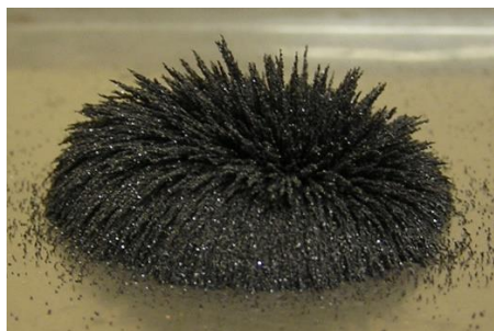
Рис. 1. Характерное образование «ежика» при воздействии магнита на магнетит
