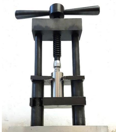
Рисунок 2. Прессовальная установка для изготовления таблеток
