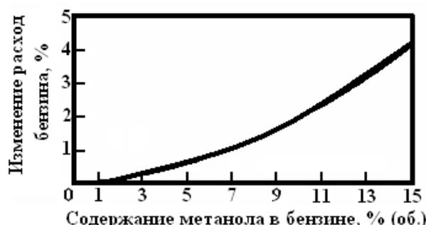
**Рис 1. Зависимость расхода бензина от количества, добавленного к нему метанола.**
