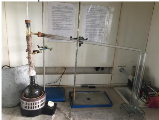
Рис. 1. Установка разгонки смолы
