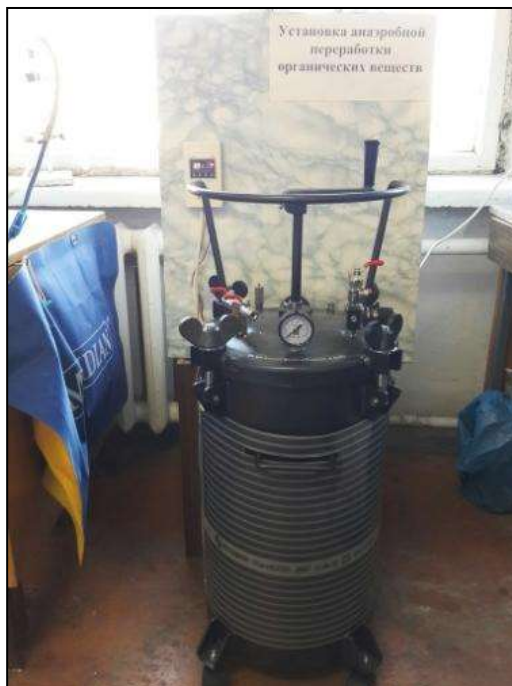
Рисунок 2. Внешний вид опытной установки анаэробного сбраживания обезвоженного избыточного активного ила
