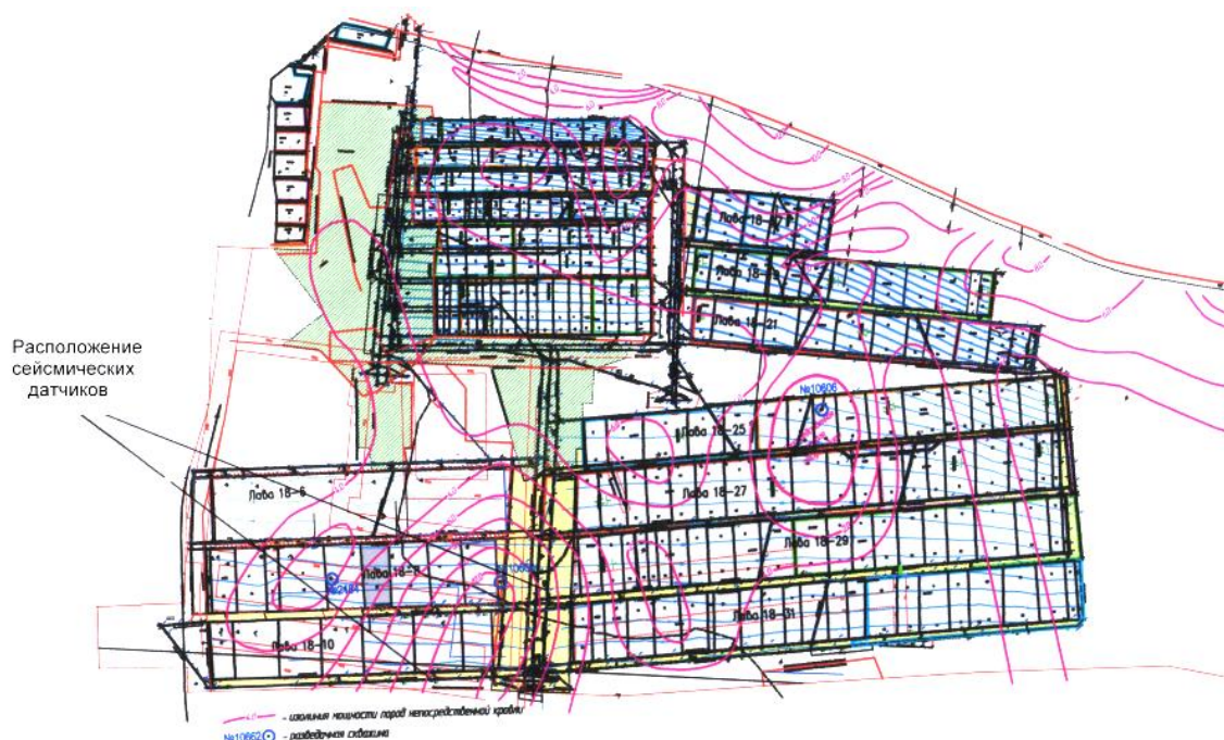
Рис. 1. Шахта Полысаевская. План горных работ по пласту Толмачевский
