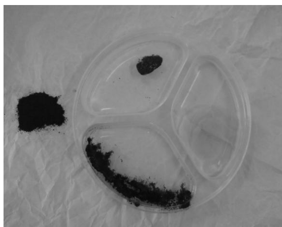
Рис. 3. Эксперимент по поглощению отработанного масла автотранспортных предприятий разработанным нефтесорбентом
