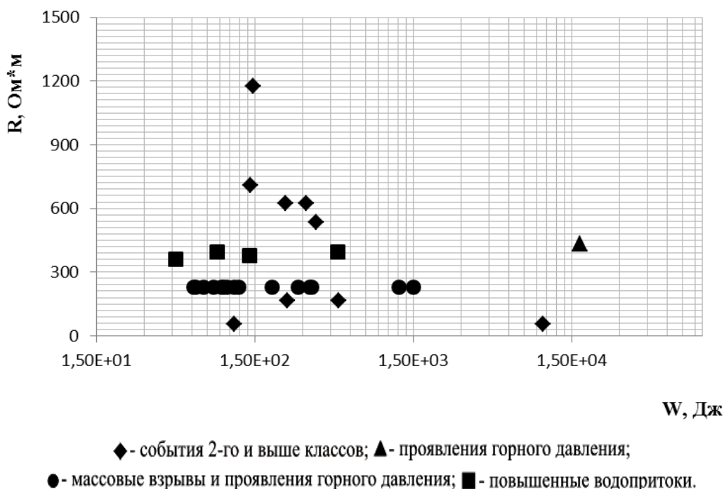
Рис. 1. График сопоставления среднего электросопротивления и энергии сейсмических волн, выделяющихся в западную часть грузового квершлага
