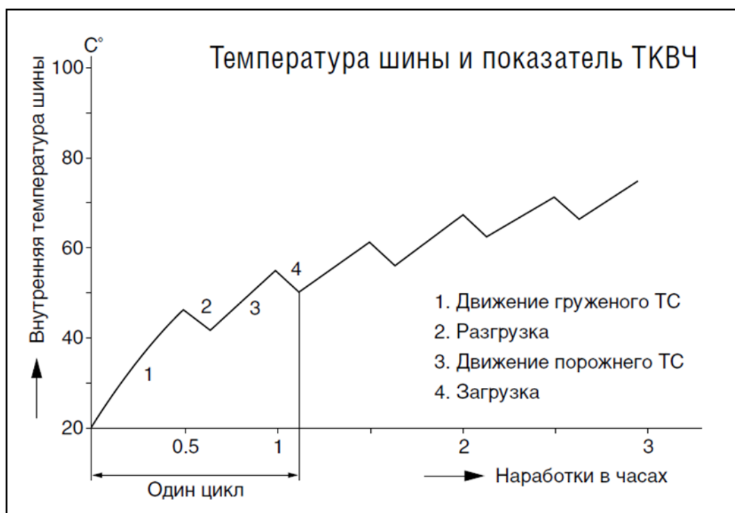
Рис. 1 – Зависимость внутренней температуры шины от показателя ТКВЧ
