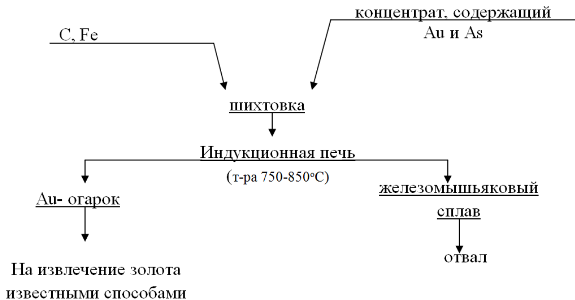
Рис. 1 - Технологическая схема получения железомышьякового сплава термической диссоциацией.
