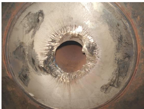
Рис.2. Общий вид поверхностей излома ротора
